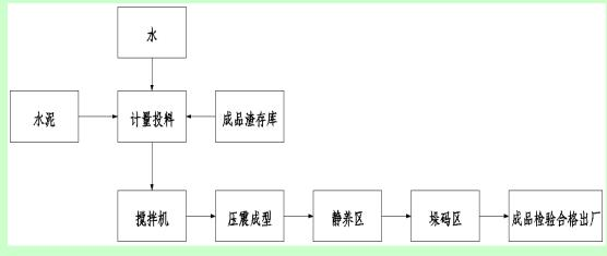
图 2-11 制砖流程图
