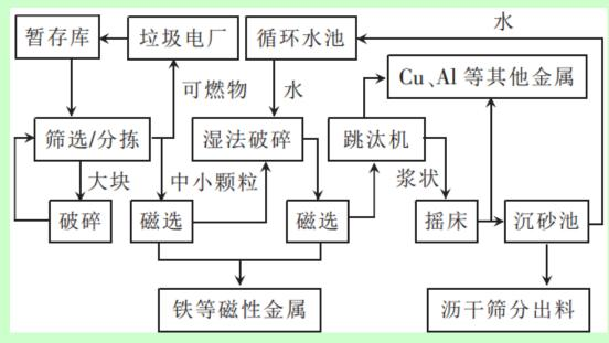
图 2-10 垃圾焚烧炉渣湿法处理工艺流程
