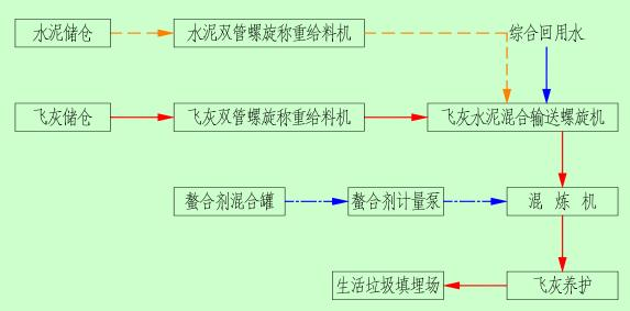
图 5-2 水泥基固化工艺流程图
