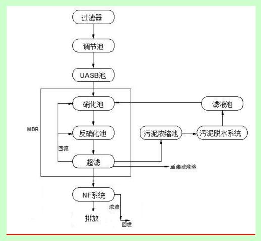
图 2-8 本项目渗滤处理工艺流程图
