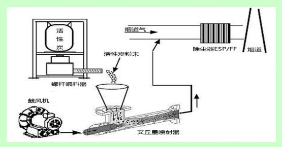
图 2-7 活性炭喷射系统示意图
