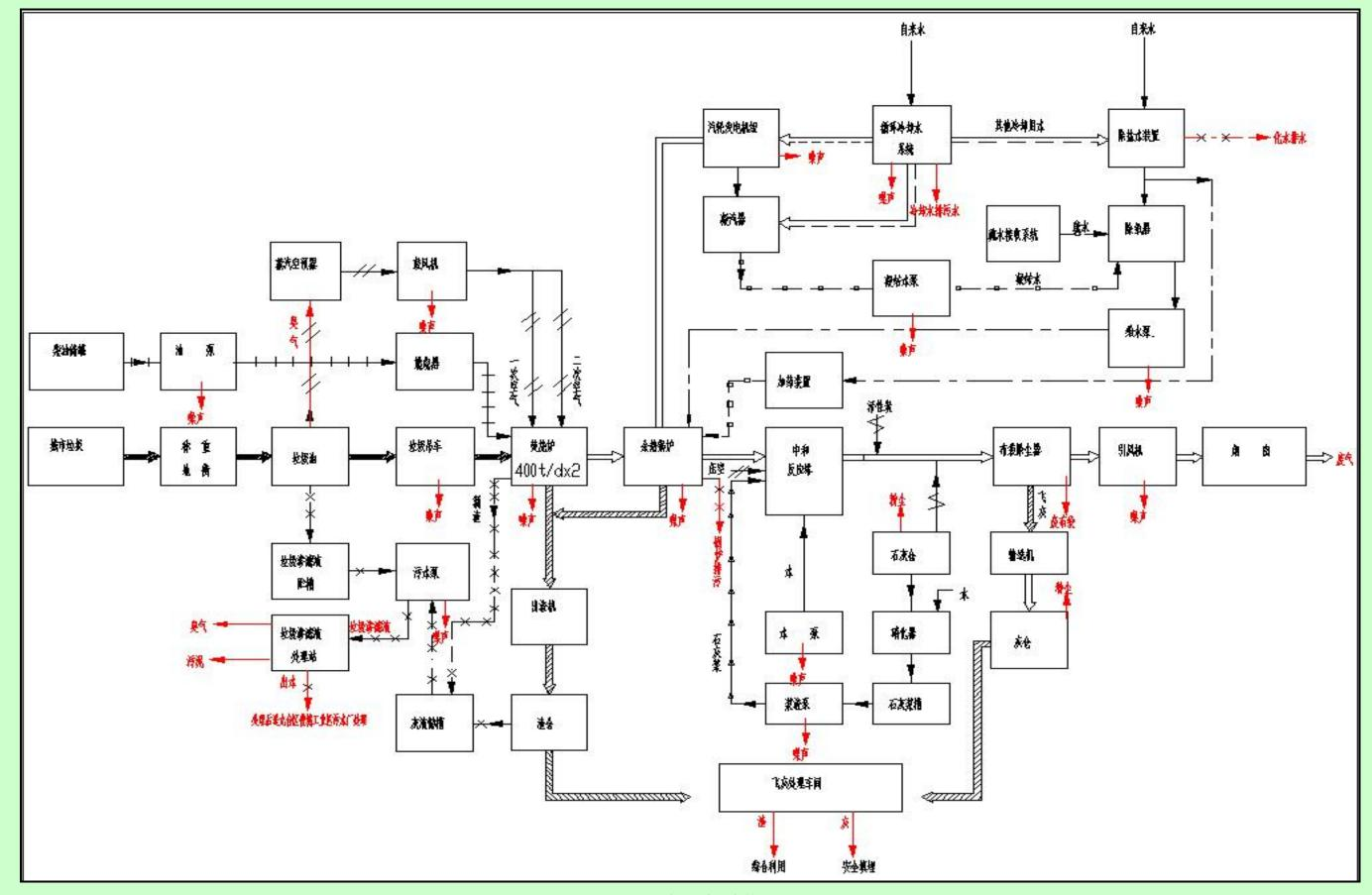
图 2-12 垃圾发电系统产排污节点图
