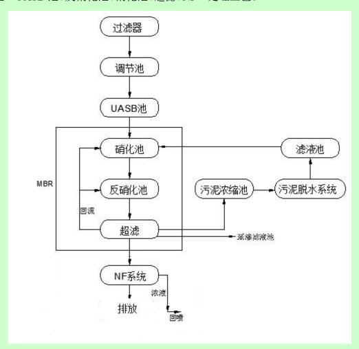
图 5-1 渗滤液处理工艺流程图
