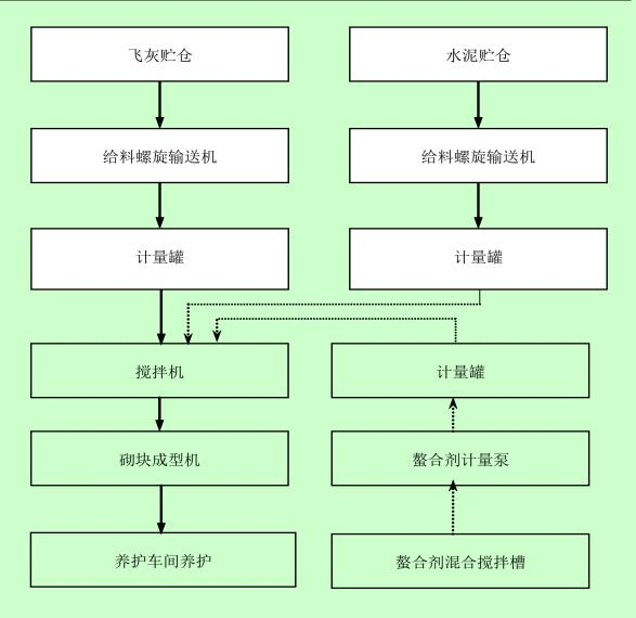
图 2-5 飞灰固化工艺流程图
