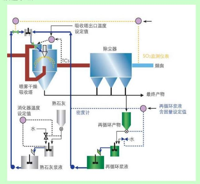
图 2-6 旋转喷雾半干法系统图
