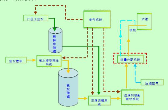
图 2-6 SNCR 工艺系统组成图
