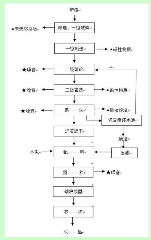
图 2-13 炉渣制砖系统产排污节点图
